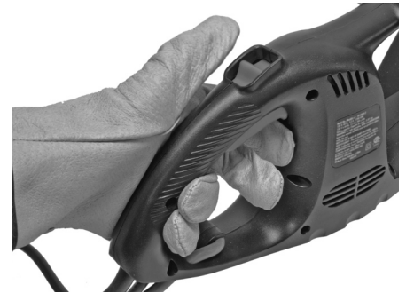
Figure 3-8 : Relâchez l'interrupteur arrière pour arrêter le taille-haie.
